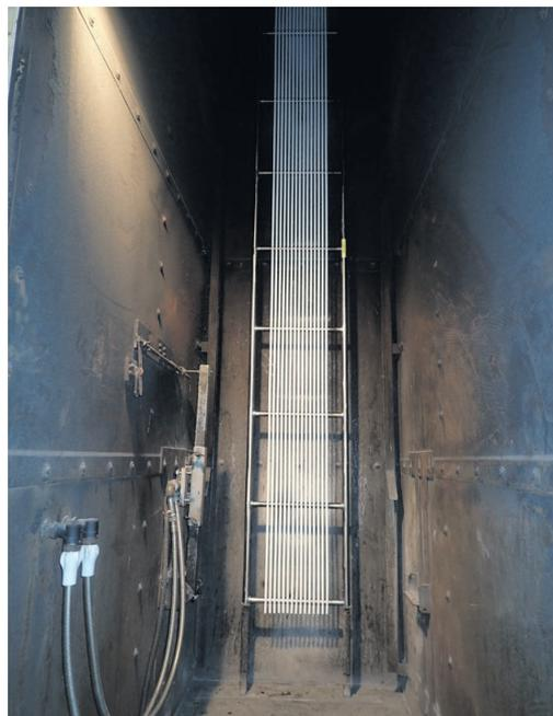
Messung der Wärmefreisetzung und Raucherzeugung von Kabeln nach EN 50399 – vor dem Versuch.
