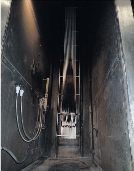
Bild 2: Messung der Wärmefreisetzung und Raucherzeugung von Kabeln nach EN 50399 – nach dem Versuch
